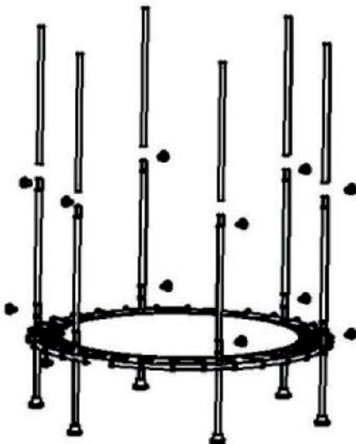
3.2 Вставьте 12 деталей внутрь соединенных деталей С и D.
